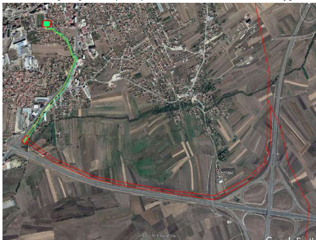
Figura 15 Pamja e trasesë së linjës 2 \times 110 kV Kosova A-F Kosova –Lipjani (ajrore/nëntokësore)
