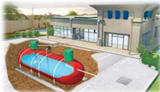
Fig.19 Sistemi i RWH-s i parafabrika për institucione apo biznese
